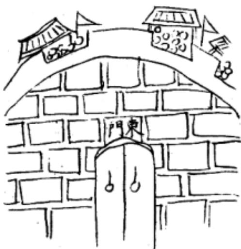
賊守城無布帳亦拆民房度為板屋每五垛置一具高出堆堞數寸凡堅守之城並用磚石將垛口砌閉只留小孔外視甚至將城加高數尺其餘營壘但築土牆木牆亦必環度板屋相離數尺即置一具如係土牆鬆不能載則植椿於地上搭板棚略高土牆數寸
