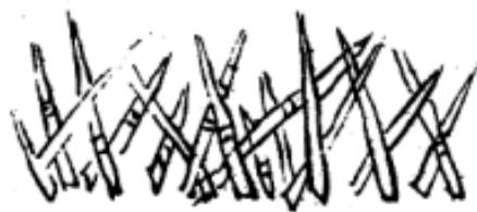
木橋多釘於江灘河灘水淺之處使我船不能近岸其土牆外濠邊卡房外亦多釘之更以荆棘繫其旁十字竹簽則釘於木橋之外取極軟竹片交叉密布礮子擊中竹簽微欹而礮子已無力墮地蓋以柔制剛也大抵賊堅守之處房屋之外必築土牆牆外開濠濠外又立木牆木牆外又開重濠濠外釘木橋前立交叉竹簽其意不過欲多一層即多一層耽延可以從容抵抗且使我兵畏難而不肯遽進耳
