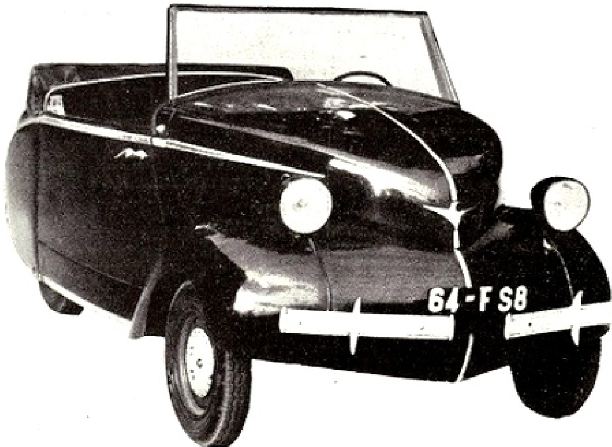
*La 2 CV Julien. Moteur à cylindre unique refroidi par air de 310 cm<sup>3</sup> placé à l'arrière de la voiture avec transmission aux roues arrière. Vitesse de pointe 65-70 kilomètres-heure.*
