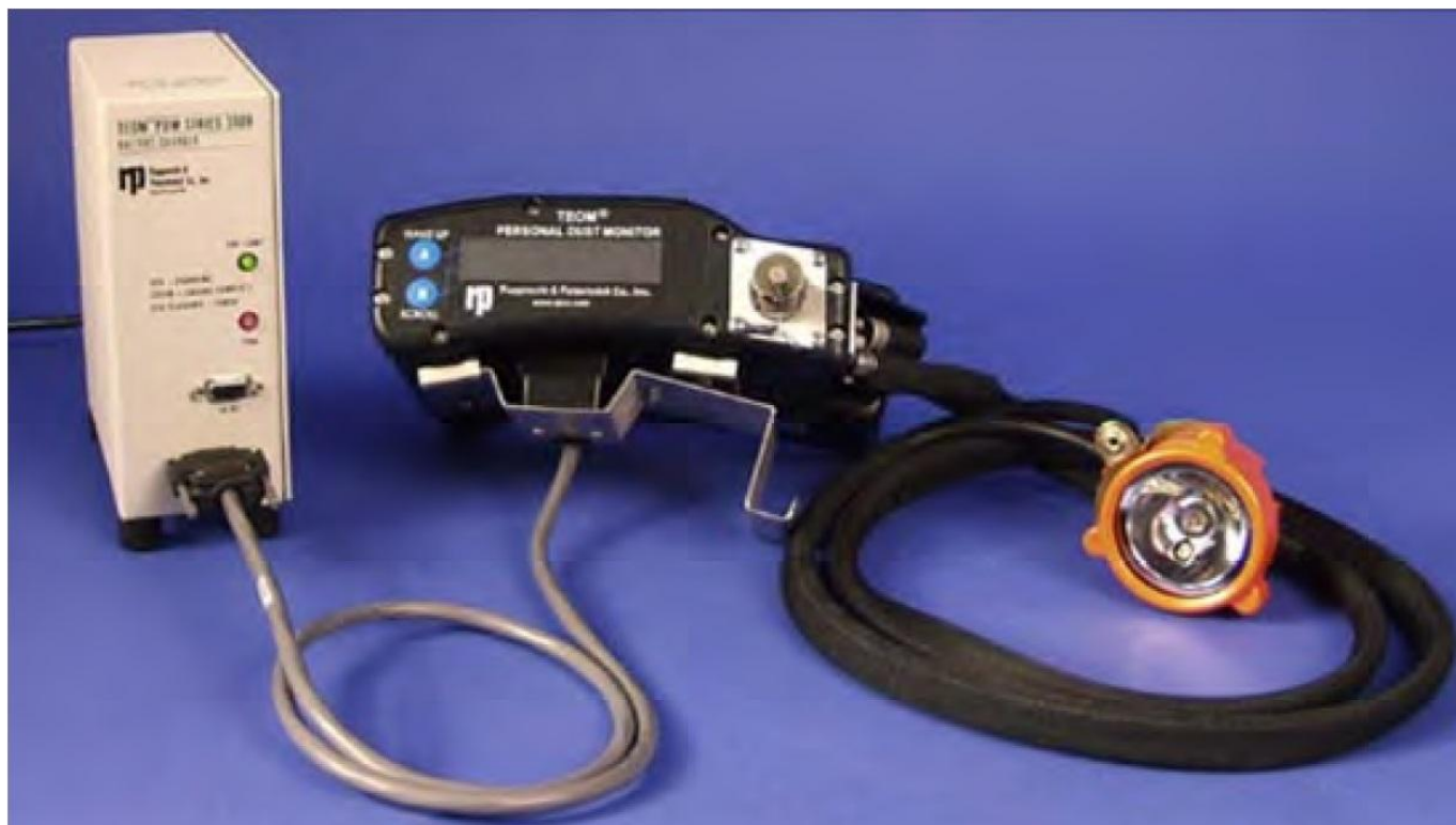
Фиг. 2. Новый персональный пылемер PDM (версия, выпущенная изготовителем до начала продаж), присоединённый к белому блоку (слева), объединяющему зарядное устройство и обеспечивающему связь с персональным компьютером через интерфейс обмена RS-232.
