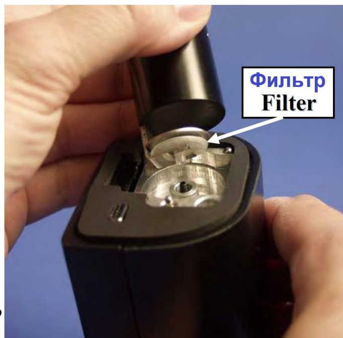
Фиг. 3 (справа). Замена фильтра на датчике нового пылемера PDM с помощью специального приспособления
