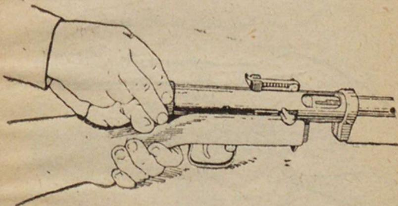
Рис. 19. Как отвинтить затыльник.
