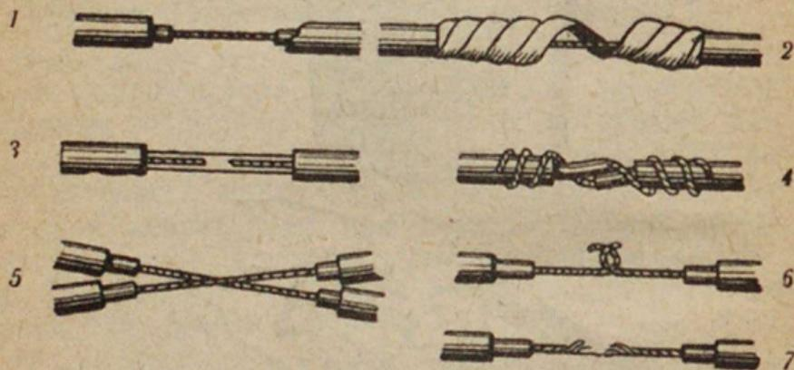
Рис. 95. Причины отказов взрыва: 1 и 2—утечка тока, 3—обрыв жилы, 4—неправильное соединение, 5—короткое замыкание, 6 и 7—плохой контакт.
