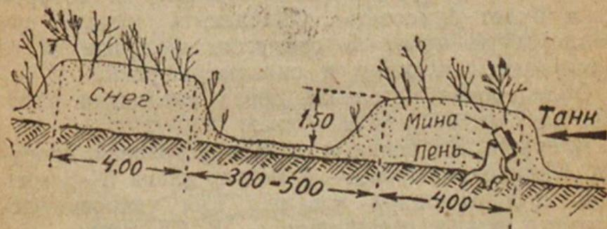
Рис. 80. Схема снежных валов.
