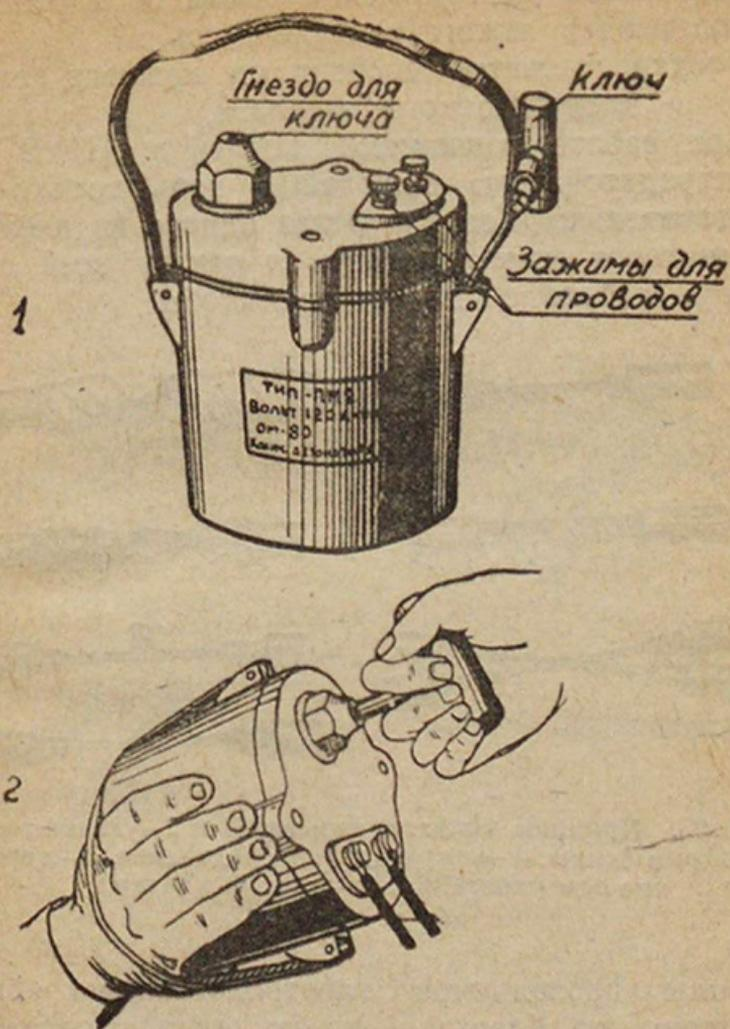
Рис 94. Подрывная машинка ПМ-2: 1—общий вид;
