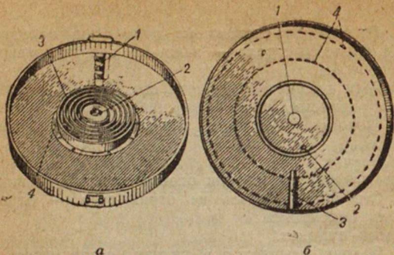
Рис. 30. а) Нижний диск магазина: 1—лоток; 2—втулка; 3—заводная пружина; 4—обруч.
