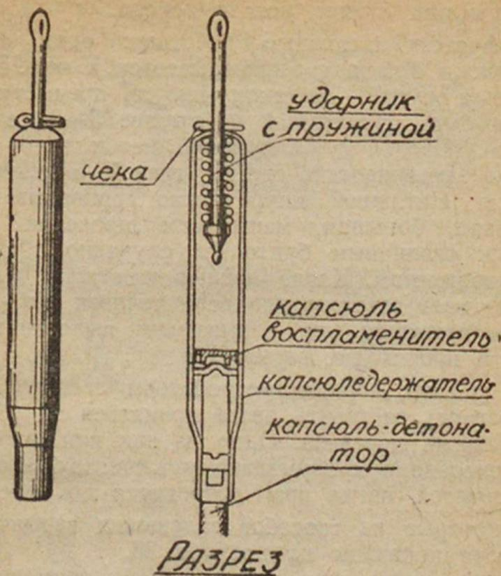
Рис. 97. Упрощенный взрыватель — УВ.
