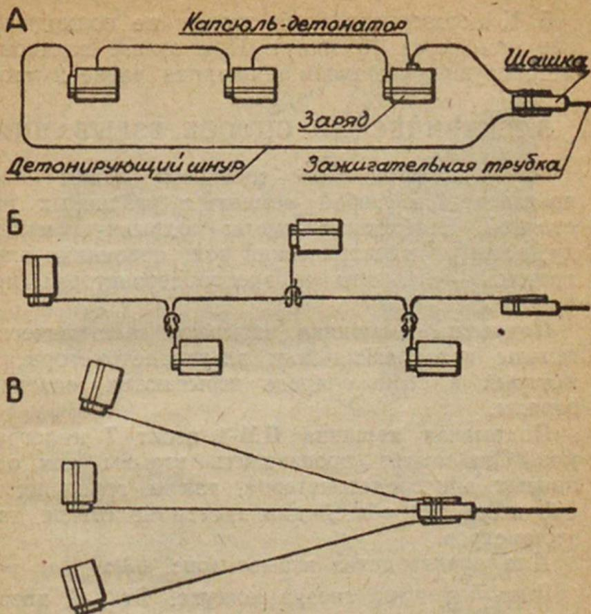
Рис. 92. Схема соединения зарядов детонирующим шнуром.
