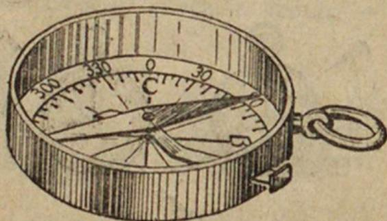
Рис. 126. Компас. Внутри корпуса видны магнитная стрелка и тормозной рычажок с выходящей наружу кнопкой.
