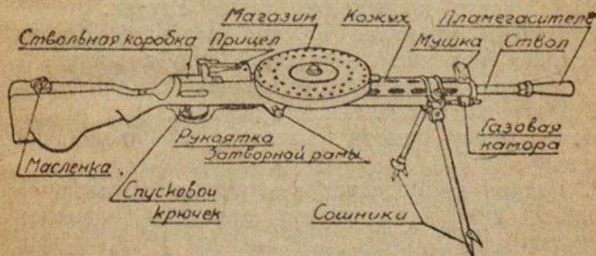
Рис. 29. Ручной пулемет ДП.
