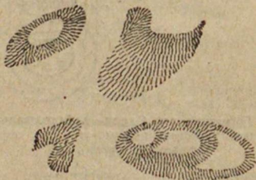
Рис. 132. Виды рельефа в штрихах. Верхний ряд: слева—котловина, справа—склон. Нижний ряд: слева—лощина, справа—вершина горы и два уступа (террасы).
