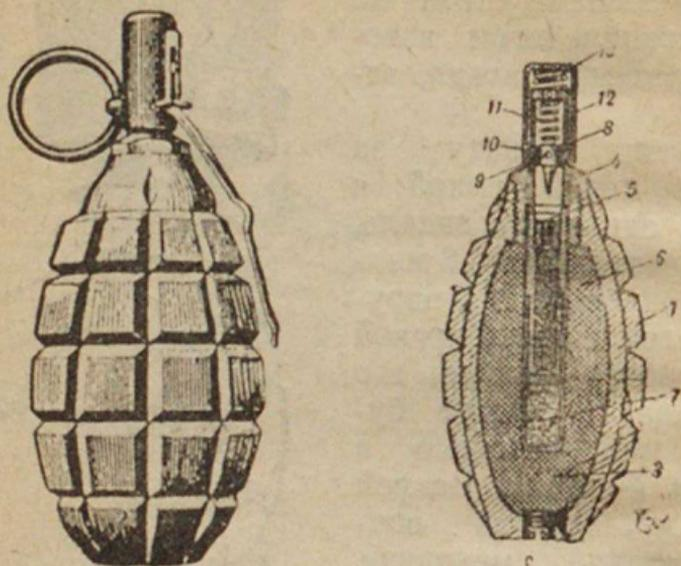
Рис. 11. Граната марки Ф-1: 1—корпус гранаты; 2—чугунная пробка; 3—разрывной заряд; 4—остов запала; 5—капсюль-воспламенитель запала; 6—пороховой состав; 7—капсюль-детонатор; 8—ударник; 9—отверстие в ударнике для предохранительной чеки; 10—шарик-предохранитель; 11—боевая пружина; 12—предохранительный колпачок; 13—пружина колпачка.
