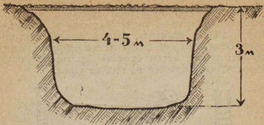
Рис. 78. Ловушка для танка.
