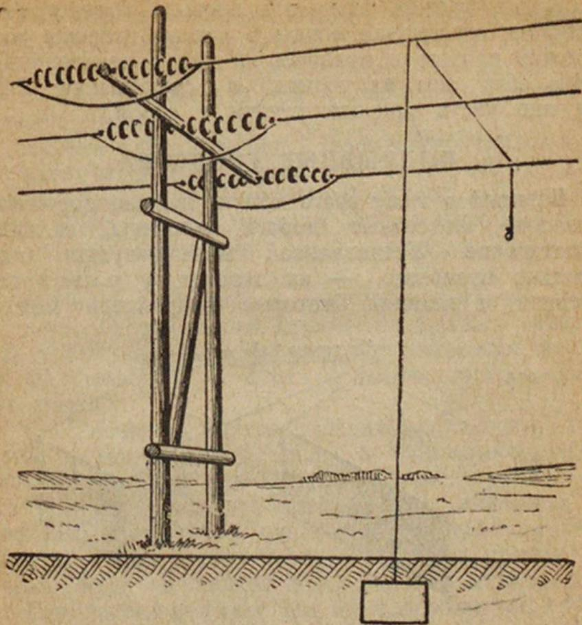
Рис. 89. Повреждение линии высокого напряжения.
