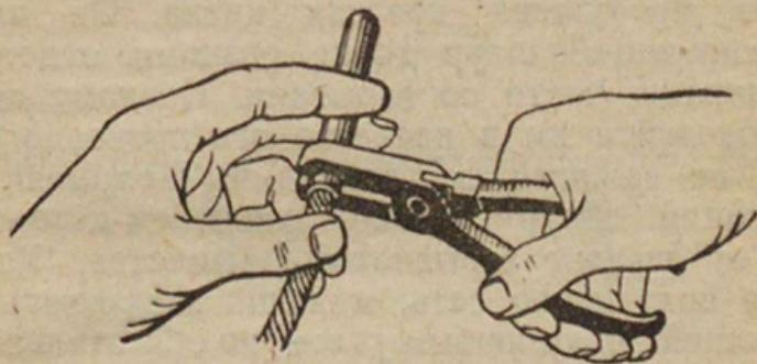
Рис. 91. Зажим бикфордова шнура в капсуле-детонаторе.
