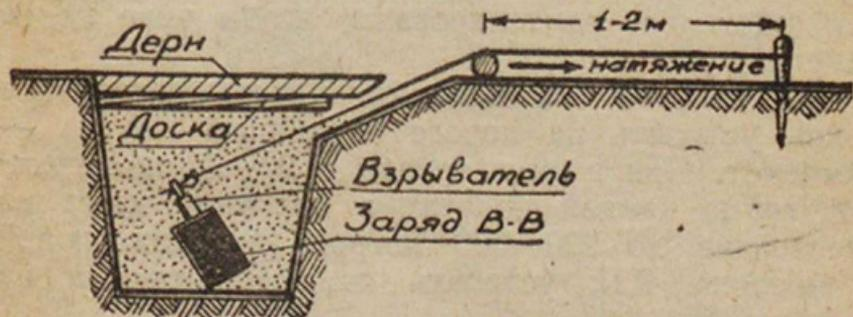
Рис. 98. Различные способы заложения мин и фугасов.
