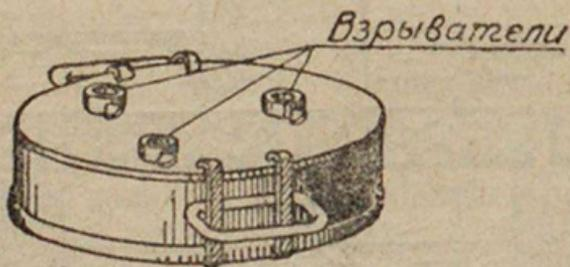
Рис. 104. Противотанковая мина.
