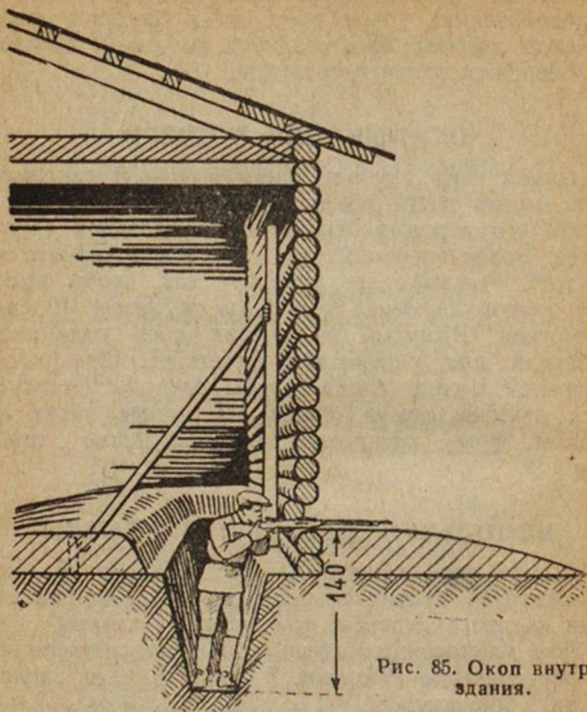
Рис. 85. Окоп внутри здания.
