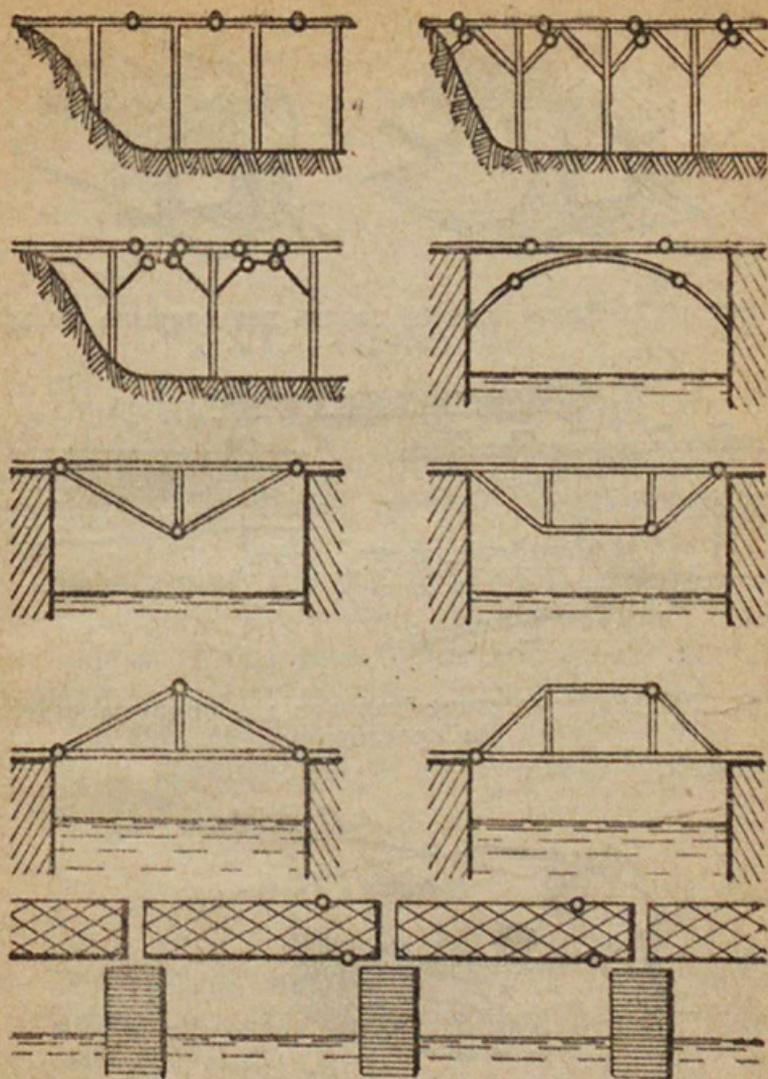
Рис. 101. Схемы подрывания мостов. Кружочками показаны места расположения зарядов
