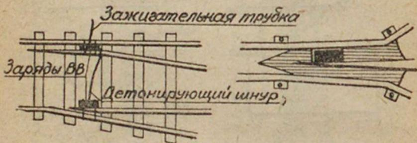
Рис. 103. Расположение зарядов для подрыва стрелки и крестовины.
