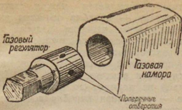
Рис. 6. Газовый регулятор.
