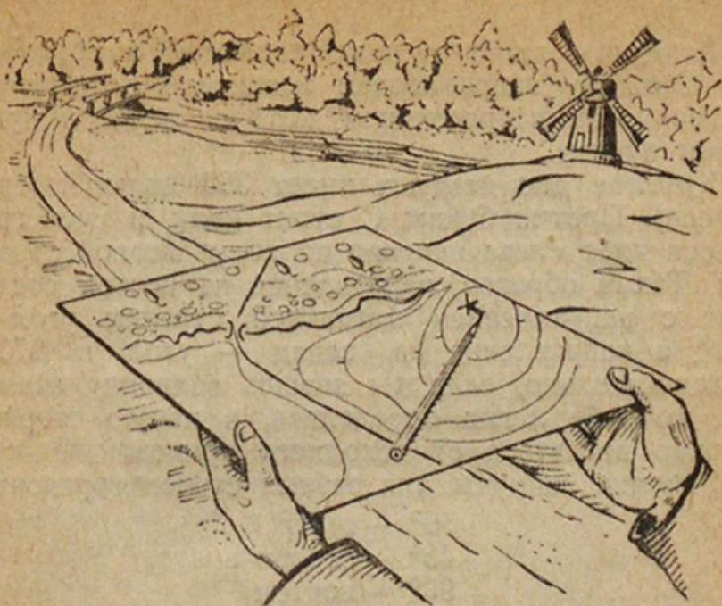
Рис. 137. Определение своего местоположения с помощью карты и компаса.
