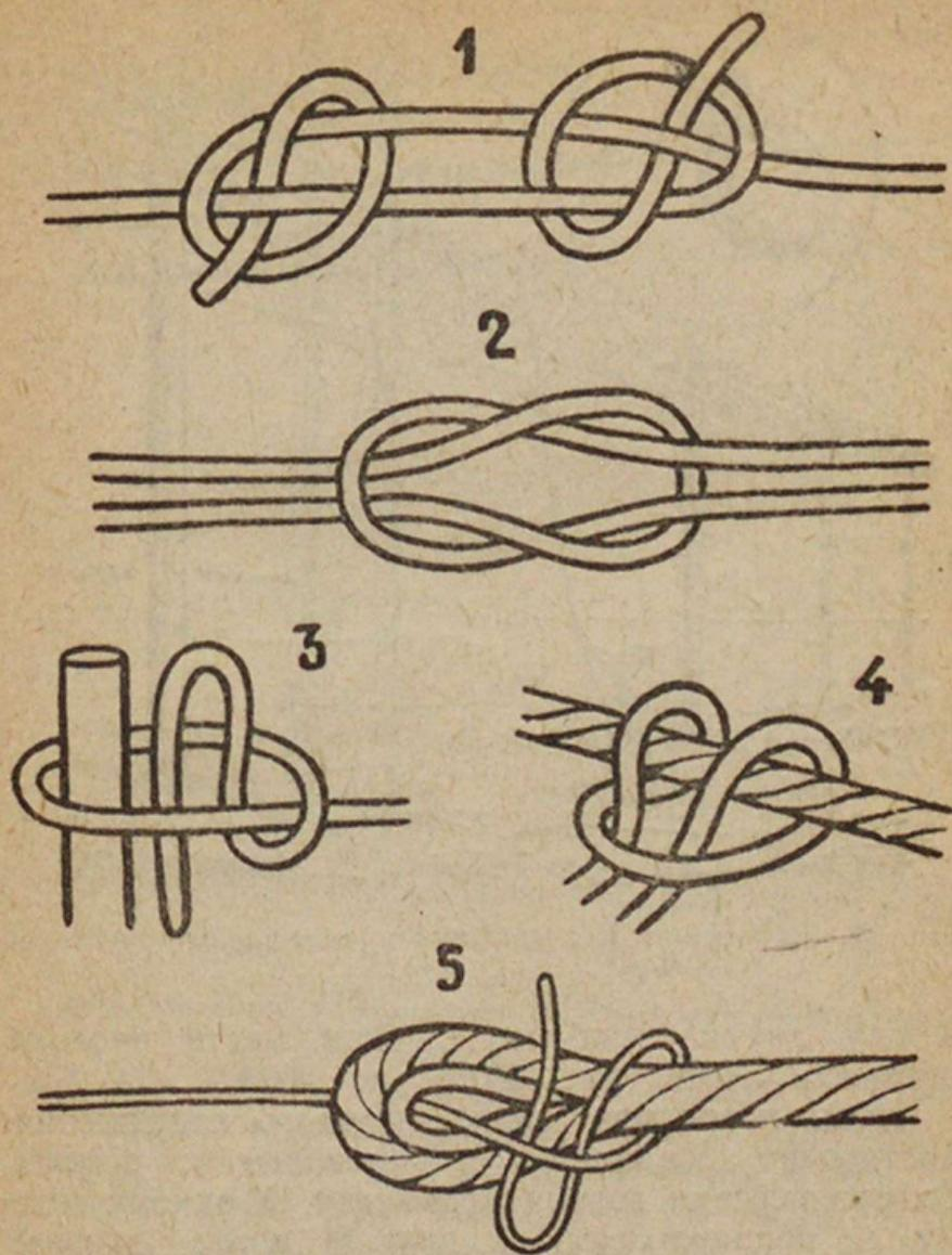
Рис. 87. Узлы: 1—концевой, 2—прямой, 3—удоборазвязываемый, 4—найтов, 5—простая перевязка.
