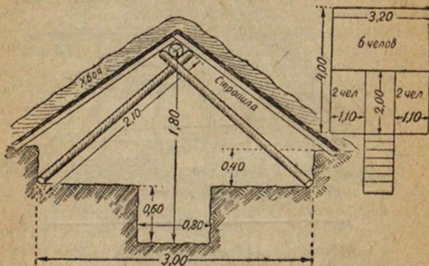
Рис. 172. Поперечный разрез и план землянки.
