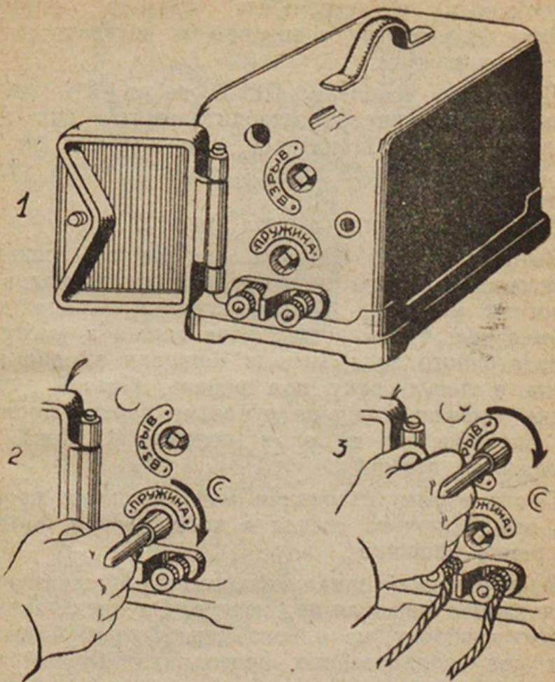
Рис. 93. Подрывная машинка ПМ-7: 1—общий вид; 2—завод пружины; 3—производство взрыва.
