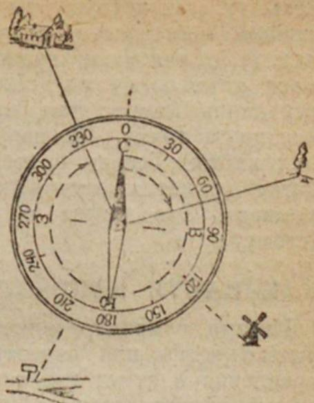
Рис. 138. Определение азимута на различные местные предметы: на дерево азимут  $70^\circ$ , на дом — азимут  $330^\circ$ .
