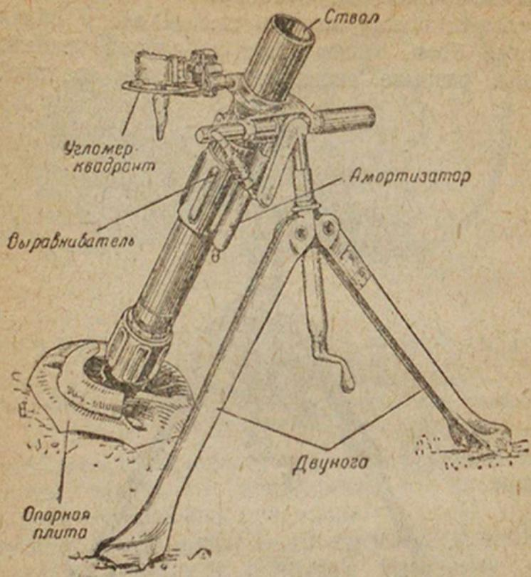
Рис. 32. Миномет образца 1940 года.
