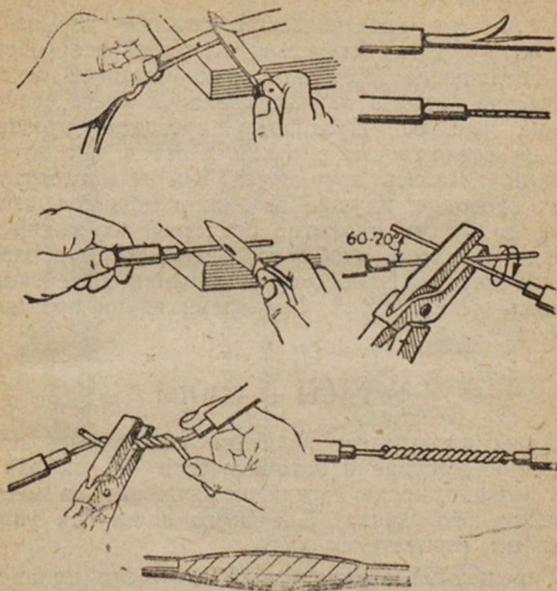
Рис. 96. Сращивание проводников.
