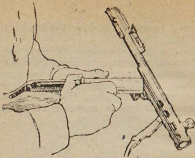
Рис. 28. Как вставить затвор со стержнем и амортизатором в затворную коробку.
