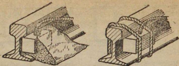
Рис. 102. Расположение заряда для подрыва рельса.
