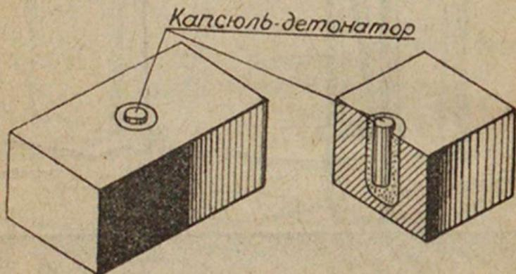
Рис. 90. Куда вставить капсюль-детонатор.
