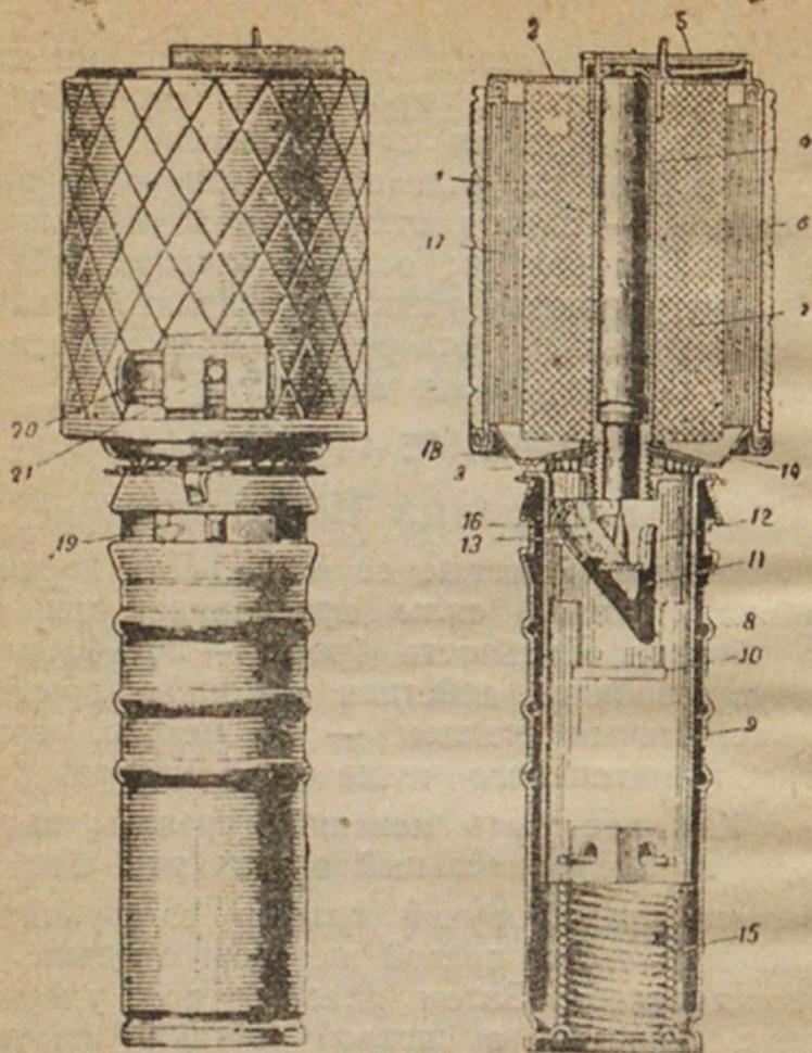
Рис. 7. Граната образца 1933 года: 1—корпус; 2—крышка корпуса; 3—тормозящая звездка; 4—центральная трубка; 5—заводка запала; 6—оборонительный чехол; 7—разрывной заряд; 8—наружная трубка рукоятки; 9—внутренняя трубка рукоятки; 10—вкладыш; 11—прорези; 12—боевая скоба; 13—ударник; 14—дно корпуса; 15—боевая пружина; 16—предохранитель запала; 17—лента; 18—опорные гайки; 19—заводка предохранителя; 20—заводка чехла; 21—штифт для закрепления чехла.
