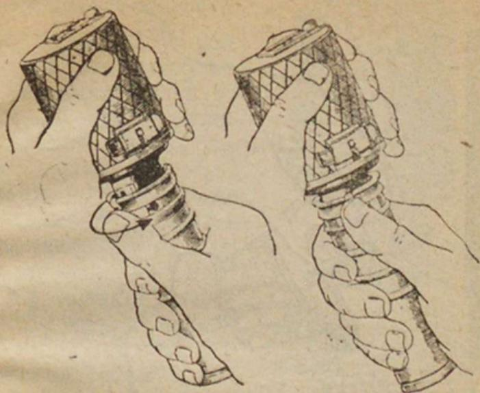
Рис. 8. Постановка гранаты на предохранительный и боевой взвод.
